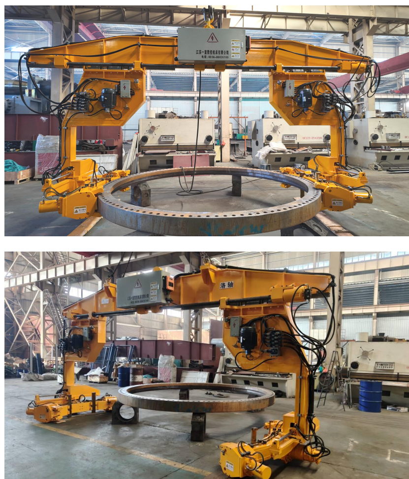
图 5 自主研发的风电回转支承智能吊架机器人
